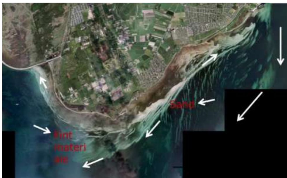
Figur 5-16 Princip for sedimentation langs Dragør Kommunes sydlige kyst. Pile indikerer dominerende materialetransport. Fra ref. /8/.
