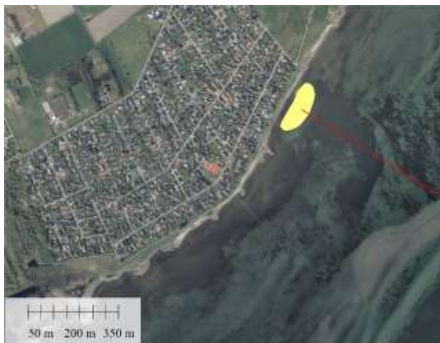
a) Opstart af indpumpning af marint sand (gul) via rørledning (rød linje).
