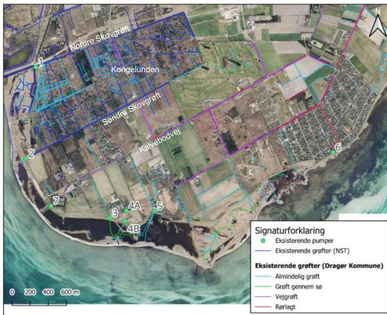
Figur 2-1 Eksisterende grøfter og pumpestationer på det sydlige Amager oplyst af Naturstyrelsen (NST) og Dragør Kommune. 1: Nordre Skovgrøft. 2: Søndre Skovgrøft. 3: Jacob Borup. 4A og 4B: TAMU. 5: Forsvaret. 6: Søvang (HOFOR). 7: Kongelundsfortet.
